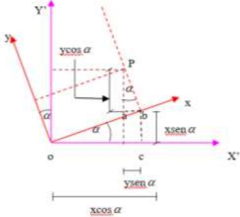
Fig. 3. Transformación de coordenadas de (xy) a (X'Y')
