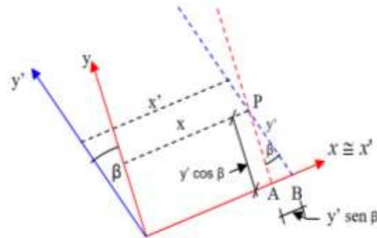
Fig. 2. Transformación de coordenadas de (x'y') a (xy)
