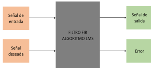
Figura 1. Esquema global del filtro adaptativo
