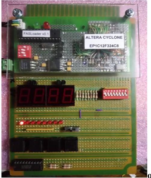
Prototipo de entrenador FPGA con el dispositivo EP1C12F324C8 de ALTERA
