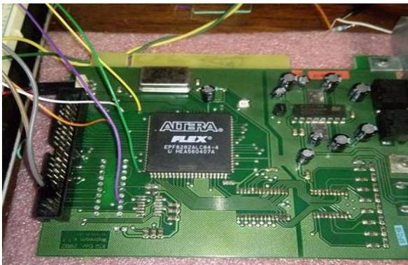
FPGA en ser sometido a pruebas, el EPF8484ALC84 aún soldado en su placa de origen
